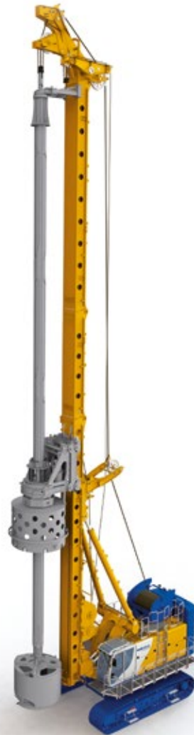
Verrohrtes Kellybohren Rohreinbau mit BTM
